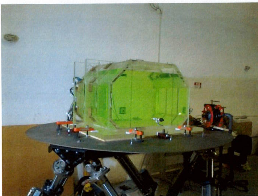
Figura 5- A montagem do tanque sobre a mesa
